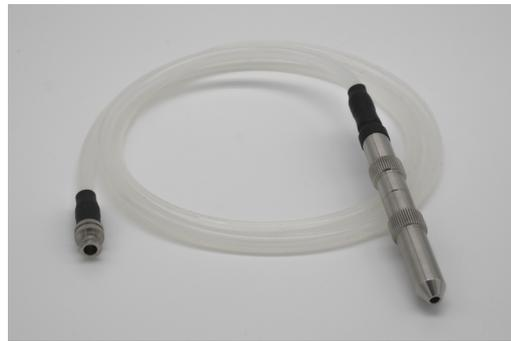
**Oberflächenbehandelte Vorrichtung aus Edelstahl mit Schlauchverbindung (Länge 1m, Innendurchmesser 3mm) und Luer-Lock Adapter zur Aufnahme des WASHchecks.de H Indikatorsystems mit Testanschmutzung zur Prüfung der Reinigungswirkung in RDG-E**
